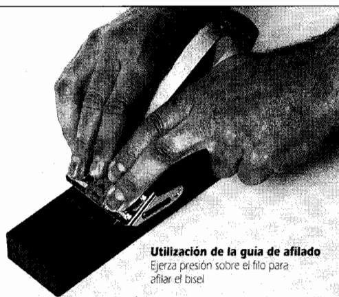
2 Incline la cuchilla para cubrir toda la piedra
