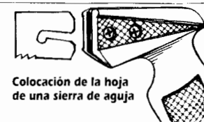
Colocación de la hoja de una sierra de calar
