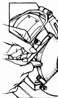
1 Reparar una punta dañada Rectifique ambos lados de la punta de un destornillador en la muela abrasiva.
