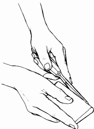
Afile el bisel interior con una piedra de afilar
