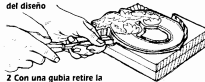
2 Con una gubia retire la madera sobrante
