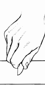
Corte angular (en dirección contraria a usted)
