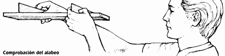
Comprobación del alabeo
