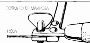
Colocación de la hoja de una sierra de calar
