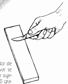
Afilado de la hoja Sujete la trincheta perpendicular a la piedra.
