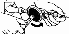
2 Para abrir el portabrocas de una taladradora de mano
