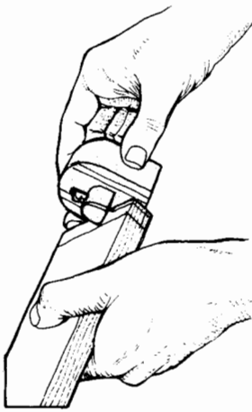
1 Marque con el gramil la profundidad del rebajo
