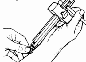
Coloque las puntas de manera que coincidan con el formón.
