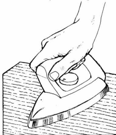
4 Caliente la cola con una plancha
